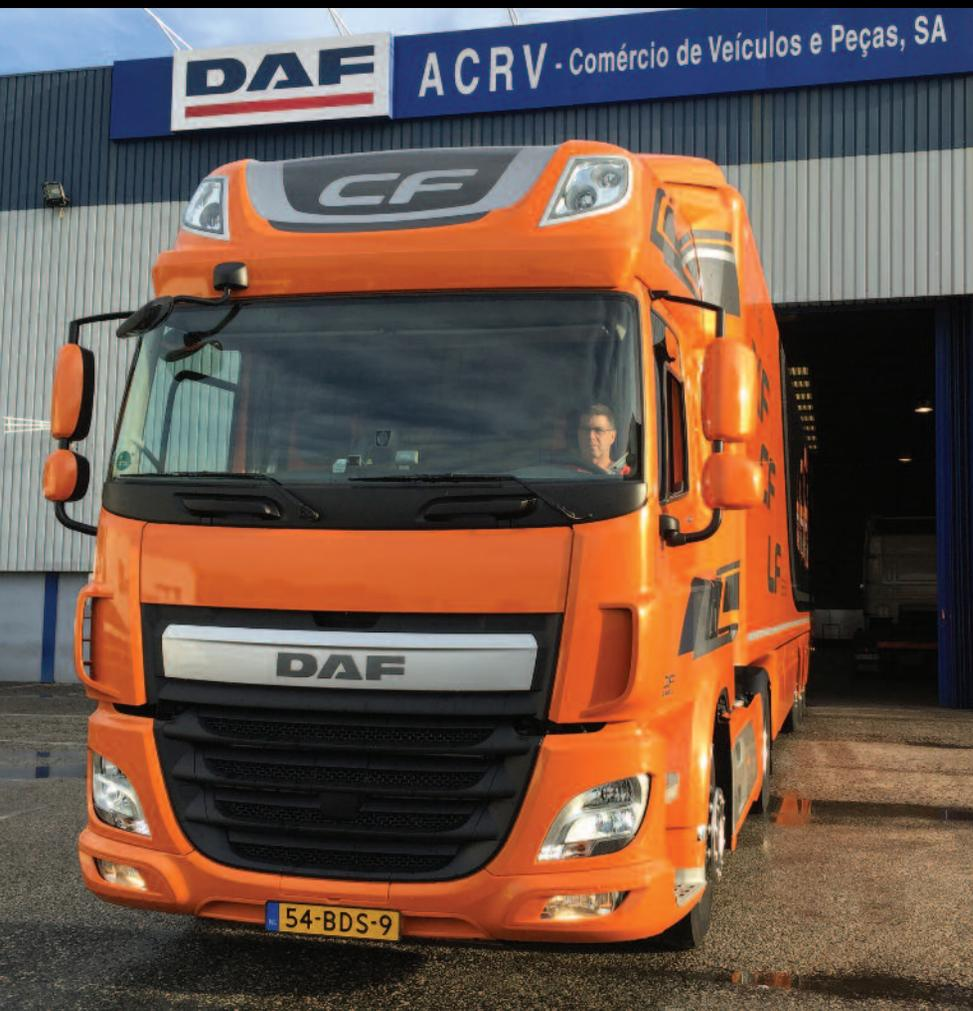
equipado com motor Paccar MX-11 Euro 6 de 10,8 litros, que debita 435 cv com sistema de injeção common rail e turbocompressor de geometria variável. Possui sistema de recirculação de gases de escape, tecnologia de redução Catalisadora Selectiva (SCR) e filtro de partículas.
